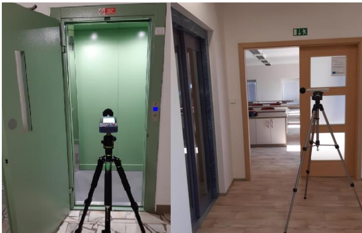
Obr. č. 2 technické měření hluku výtahových dveří
